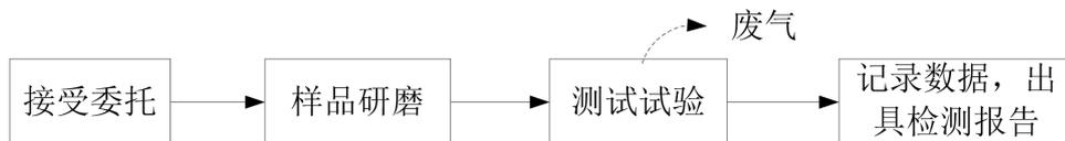
图 15 燃烧热值试验流程及产排污环节图
